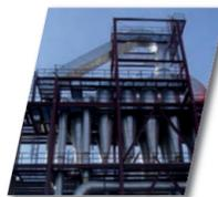
干燥器的工作原理是在最短的停留时间内实现纯对流。干燥器的主要部件为提升式送料机，干燥塔，旋风系统，风机以及其他基于设计需要的特定配备。
